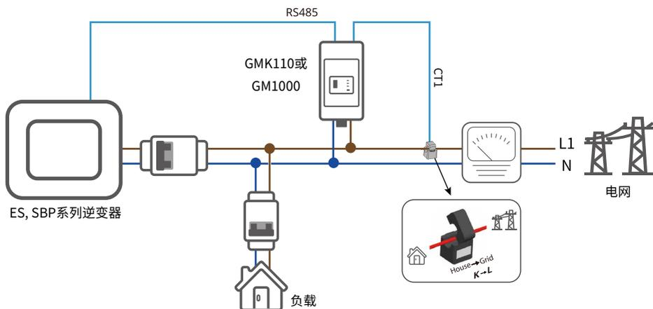
当使用的负载为单相负载,且使用SBP系列逆变器搭配光伏逆变器组成自发自用场景时,SBP系列逆变器可搭配GM1000D或GMK110D双CT电表实现防逆流功能,光伏并网逆变器如何实现防逆流功能需根据具体使用的逆变器型号进行匹配。为确保防逆流功能严格实现,可能会存在负载用电量从电网获取的情况,以下组网接线方案仅供参考。
