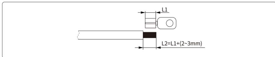
2. 将剥好的线缆插入冷压端子内，并使用压线钳压紧，如下图
