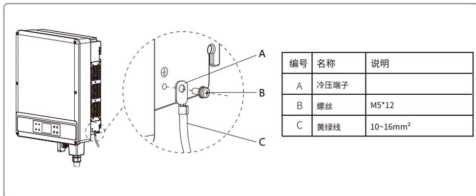
4. 为提高端子的防腐蚀性能，建议在接地线缆组装完成后，对接地端子涂抹硅胶进行防腐蚀保护。
