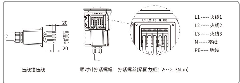
交流电线的线缆规格如下图所示。
