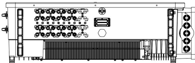
当PV组串数 $\leq 8$ 时，将PV组串从MPPT1到MPPT8依次接入到逆变器。
