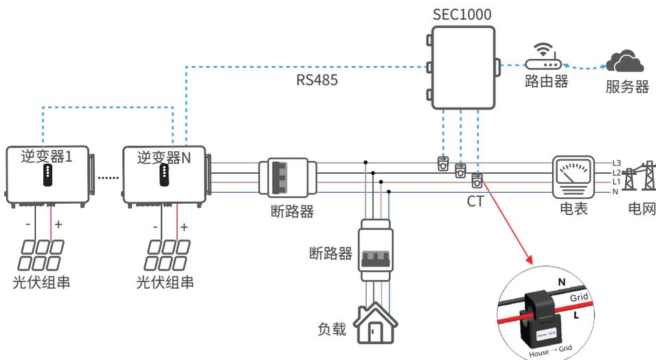
如有功率限制功能需求,在完成接线后,可通过SolarGo App开启防逆流功能,通过LCD或ProMate设置相关参数。
