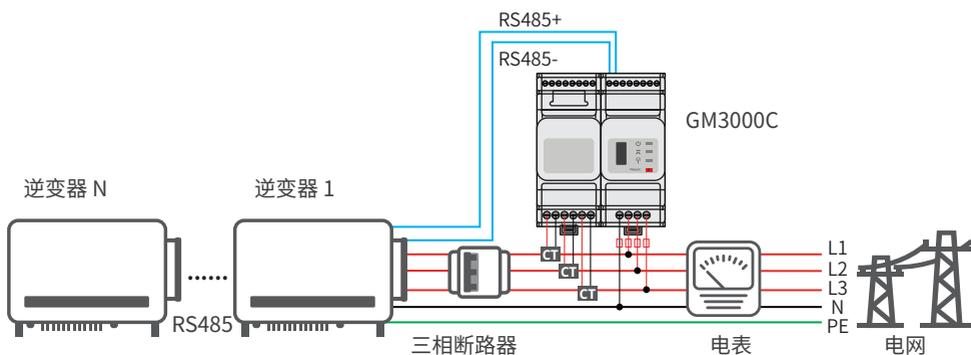
接线完成后, 通过LCD显示屏或SolarGo App设置相关参数, 完成防逆流或输出功率限制功能。
